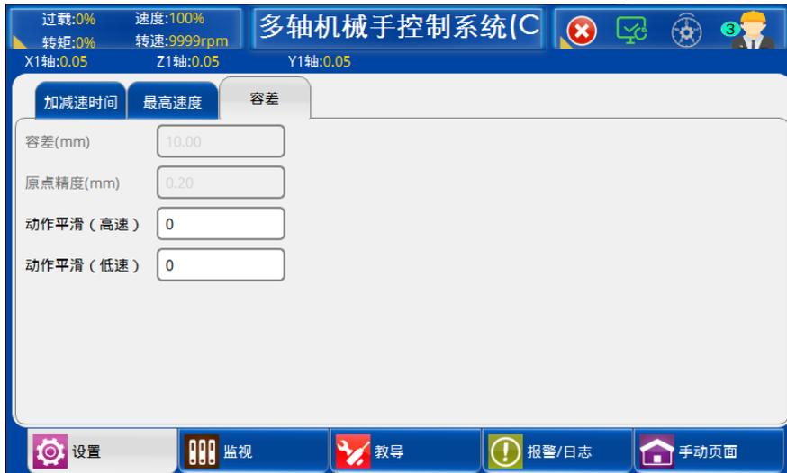
动作平滑（高速）：机械运行的动作平滑度设置，最小值为 0，最大值为 200。
