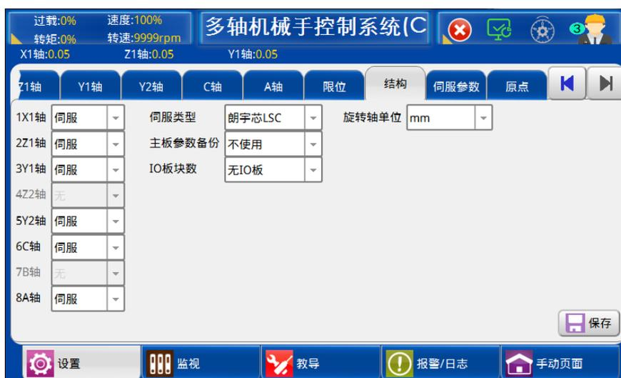
请根据驱动器具体规格，在本控制系统的“结构”页面选择正确的编码器位数。
