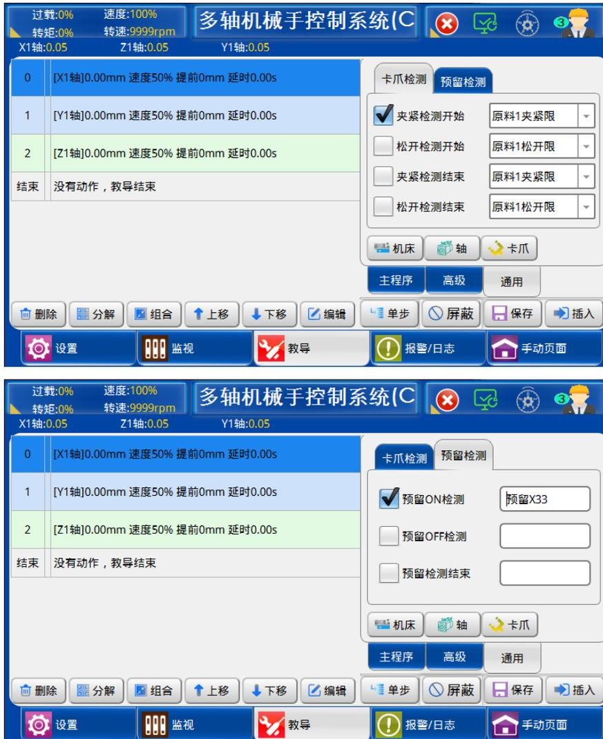
教导卡爪的动作后，点击需要检测确认信号的程序步后，再点击  使其变成 ，再点击【插入】按钮将该检测程序插入到所选择程序步的前面，程序从此步开始检测卡爪的确认信号。
