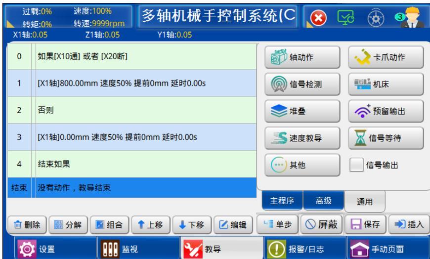
以上程序中，若条件 1（X10 通）、条件 2（X20 断）其中有一个满足，则执行 X1 轴横出 800.00mm；若条件 1（X10 通）、条件 2（X20 断）两者都不满足，则执行 X1 轴横入 0.00mm。
