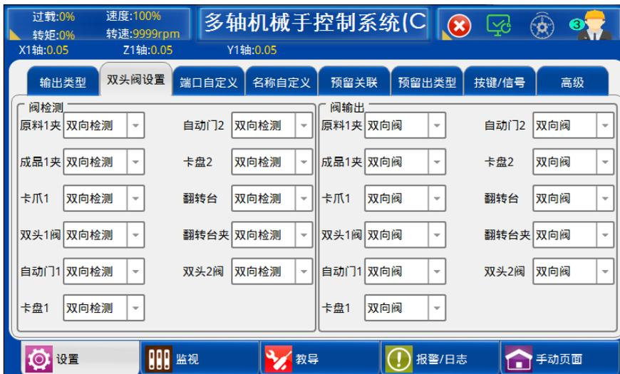
1) 阀检测：检测相应动作的输入信号。
