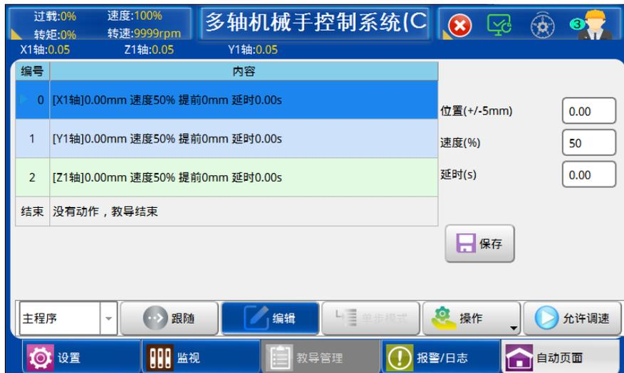
在该对话框可修改该动作的延时时间、轴的速度和位置，更改参数后再点击【保存】键，参数会被在线接收，从下个循环开始会按更改后的参数运行，要取消编辑可按【编辑】按钮使其变为白色。
