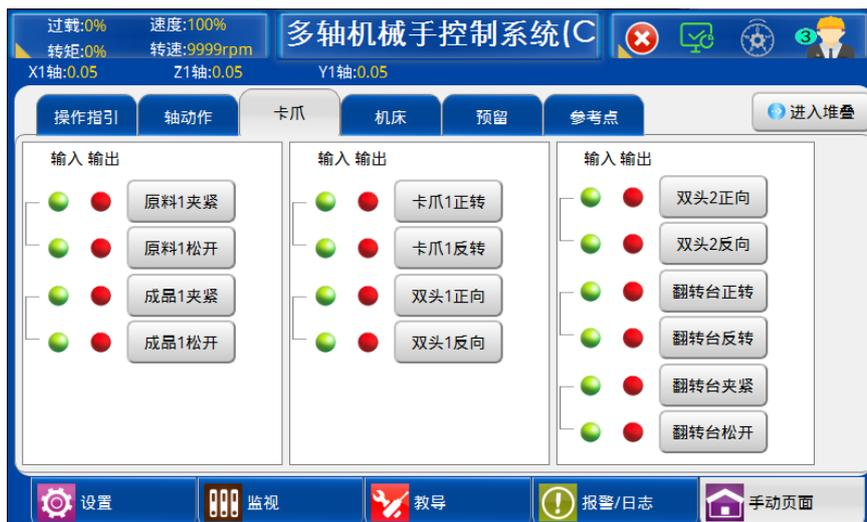
点击其中一个【原料 1 夹紧】按钮，即相应的卡爪输出动作，点击按钮【原料 1 松开】即相应的卡爪断开动作。
