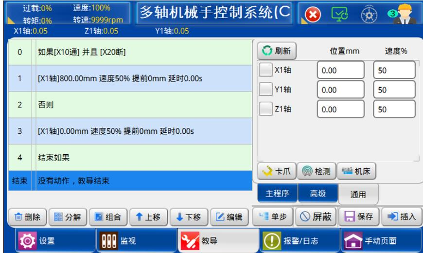
以上程序中，若条件 1（X10 通）、条件 2（X20 断）两者同时成立，则执行 X1 轴横出 800.00mm；若条件 1（X10 通）、条件 2（X20 断）其中有一个不满足，则执行 X1 轴横入 0.00mm。
