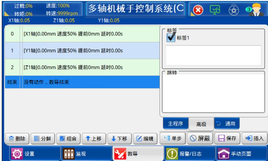
标签功能：教导师程序中，在需要注释的地方插入【标签】，如上图，编辑完内容后插入即可。
