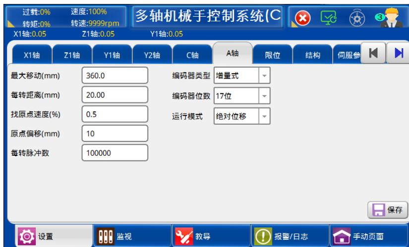
A 轴参数设置和 C 轴参数设置相同，参考见 5.7.5 节【C 轴设置】。
