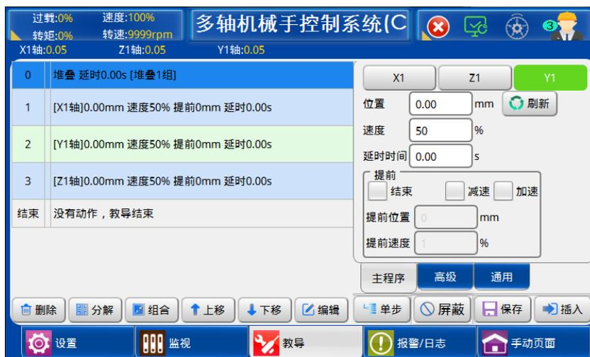
当轴的堆叠的个数不为 0 时，可以在此页面设置起始位置，堆叠轴的速度，延迟时间，提前结束、提前减速、提前加速等参数的设置。
