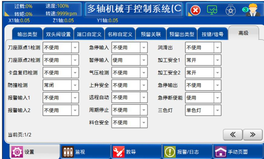
不使用：机械手不检测刀座原点 2 信号，即 EX12 信号。
