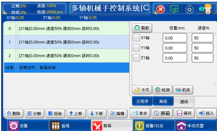
1、在该页面可对各个轴的位置、动作速度、延时时间进行设定，点击轴左边的使其变成图标, 然后设定好该轴的参数，选中页面左边的程序步，再点击【插入】按钮即可将所编辑的轴动作插入到所选中程序步的前面。
