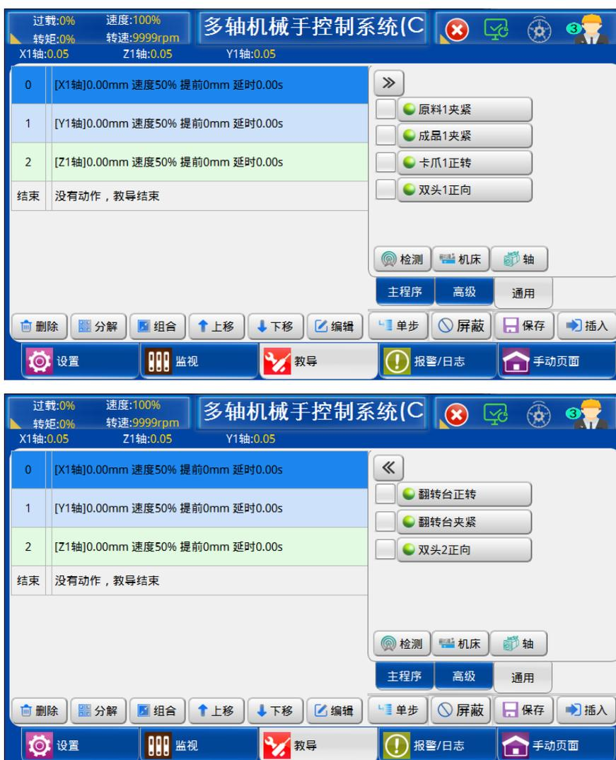
控制器可控制有七组卡爪动作，按“>>”键来切换可教导的卡爪动作。点击信号选择卡爪的状态，再点击左边的使其变成，再点击【插入】按钮将该动作插入到所选择程序步的前面。
