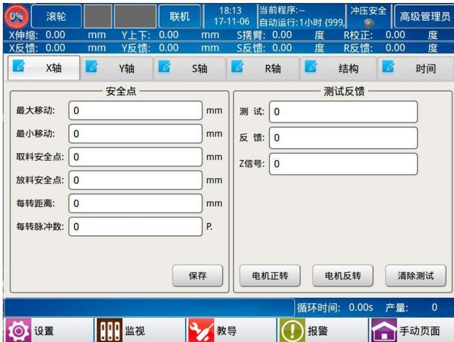
最大移动：设定各伺服轴的最大移动机械长度。
