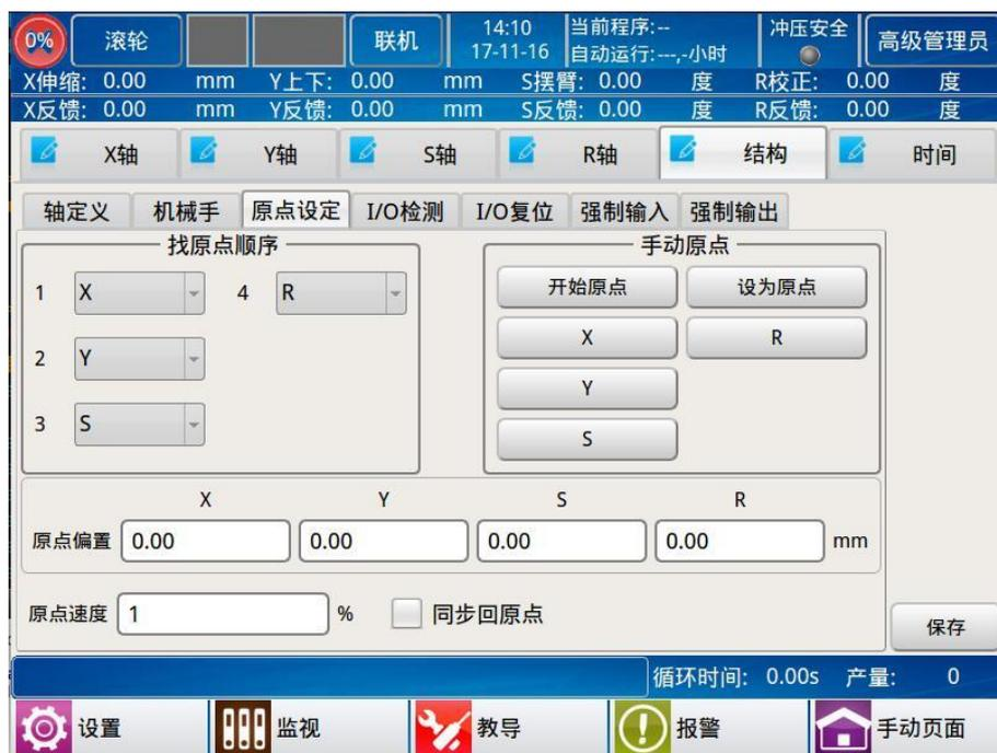
**I/O 检测:** 对其打勾就代表该输出阀需要检测，在自动运行过程中如果已经勾选检测的阀在设定时间内，没检测到输出信号实际没输入，系统就会报警。
