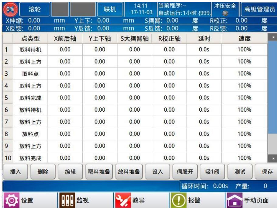
编辑菜单中有【插入】、【删除】、【编辑】、【取料堆叠】、【放料堆叠】、【设入】、【伺服开】、【吸1阀】、【测试】、【保存】10个选项。
