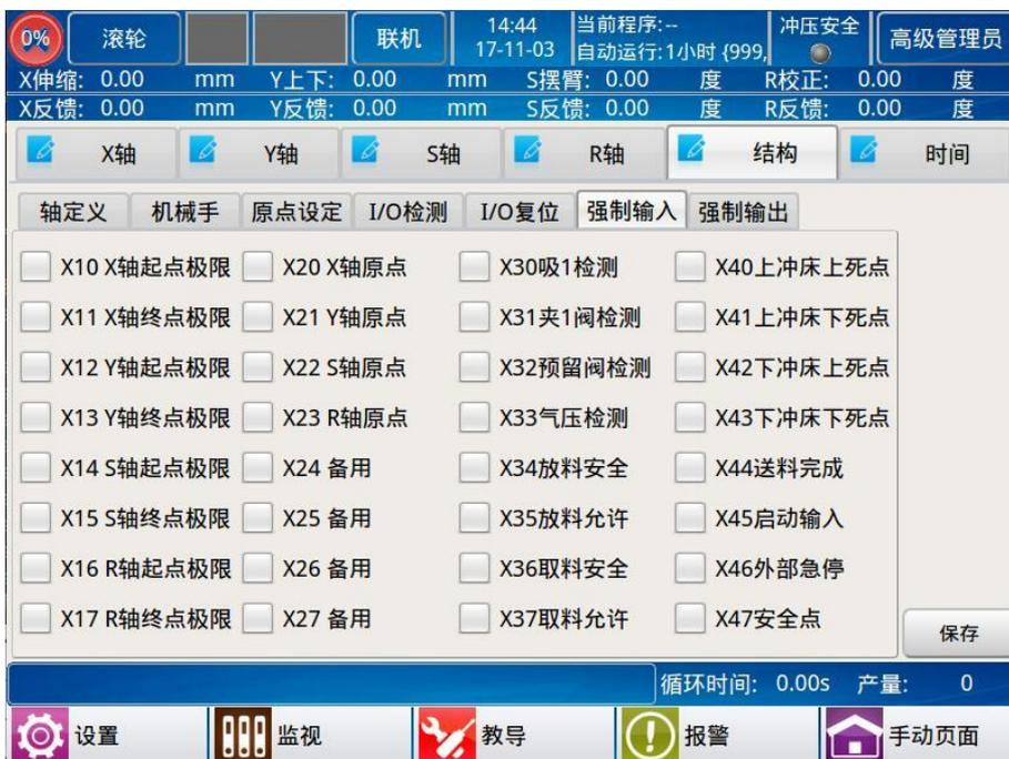
**强制输出：**勾选输出点，可以强制输出信号。
