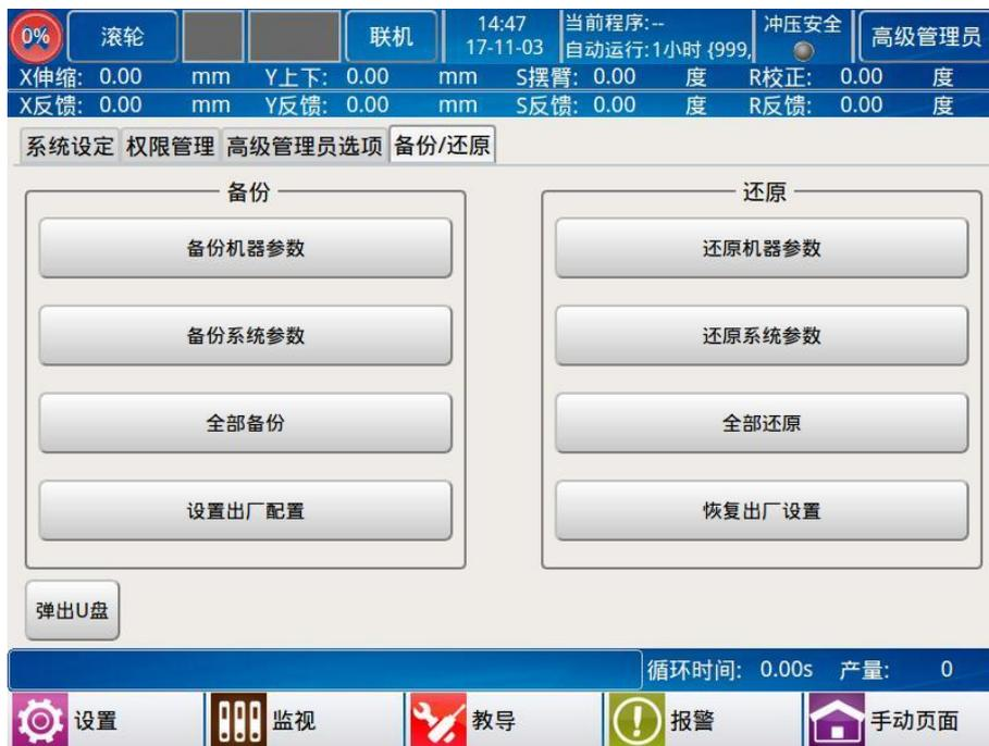
机器参数：指的是轴参数的设置，其中包括软限位、取料安全点、放料安全点，每转距离。
