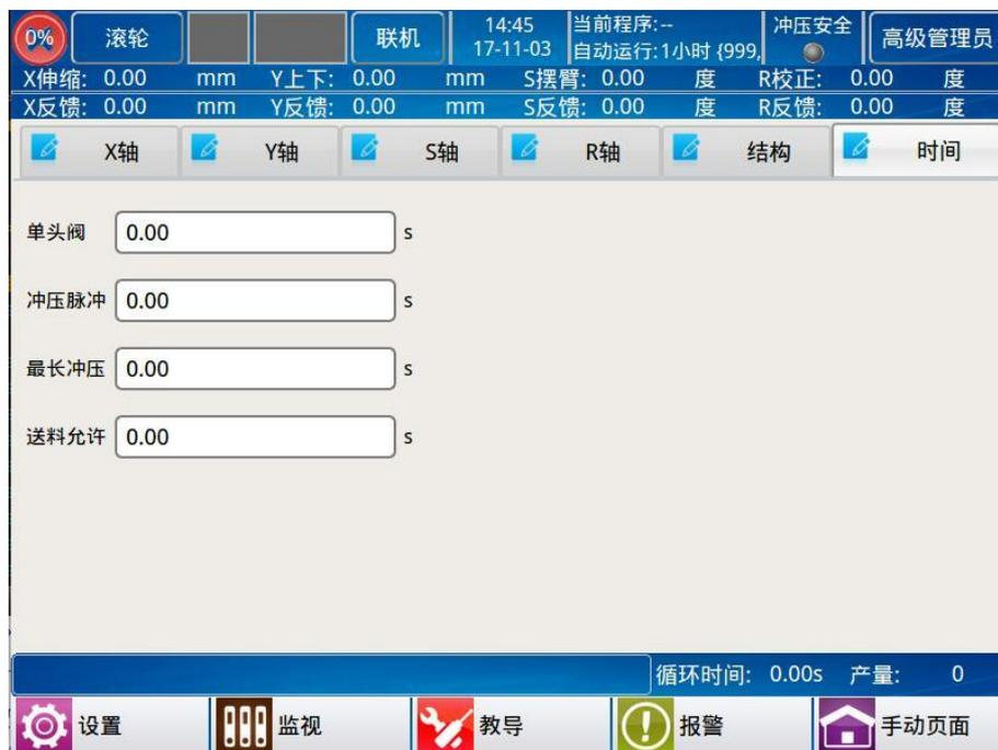
单头阀时间：气动阀在规定的时间内没有检测到输入信号就会报警。
